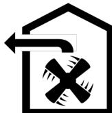
Die aus der Mitte der Kochstelle angesaugte Luft wird durch Ölfilter geleitet und über ein Rohrsystem durch den Kamin nach außen abgeleitet.
