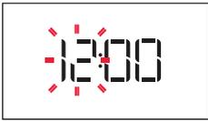
Začnú blikať dve číslice označujúce hodinu: Otočením gombíka nastavte hodinu a stlačením potvrdte.
