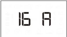
Den Auswahlknopf zur Auswahl des Nennstroms drehen, anschließend
