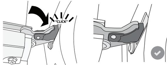
**5.** Versuchen, die Tür zu schließen und sicherstellen, dass sie auf das Bedienfeld ausgerichtet ist. Ist dies nicht der Fall, die oben aufgeführten Schritte wiederholen: Die Tür könnte beschädigt werden, wenn dies nicht richtig funktioniert.
