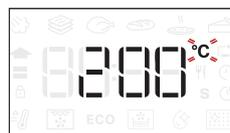
Wenn das Symbol °C auf dem Display blinkt, den Knopf drehen, um den Wert zu ändern, anschließend
