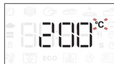
Kad ikona °C treperi na zaslonu, okrenite gumb za promjenu vrijednosti pa pritisnite za potvrdu te nastavite s promjenom sljedećih postavki (ako je moguće). Istovremeno možete postaviti i razinu roštilja (3 = visoka, 2 = srednja, 1 = niska).
