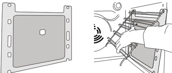
Lai nodrošinātu labāko katalītisko plātņu paštīrošo īpašību sniegumu, krāsns ieteicams uzsildīt līdz 200 °C, karsēt aptuveni stundu un izmantot funkciju „Convection Bake”. Šajā laikā krāsnij jābūt tukšai. Pēc tam ļaujiet krāsnij atdzist un tikai tad iztīriet ēdienu atliekas, izmantojot maigu sūkli.
