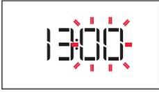
Začnú blikať číslice označujúce minúty. Otočením gombíka nastavte minúty a stlačením potvrdte.
