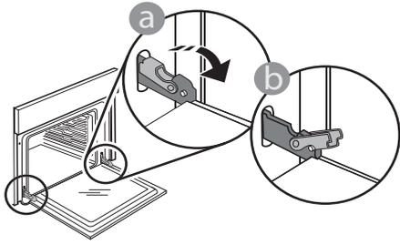
**2.** Zatvorite vrata koliko god to možete. Čvrsto uhvatite vrata s obje ruke; ne držite ih za ručku. Vrata jednostavno skinite tako da ih nastavljate zatvarati dok ih istovremeno vučete prema gore dok se ne otpuste iz ležišta. Stavite vrata sa strane, oslanjajući ih na meku površinu.
