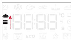
A fázis végeztével hangjelzés hallható, és a kijelzőn üzenet jelzi, hogy a sütő elérte a megadott hőmérsékletet.
