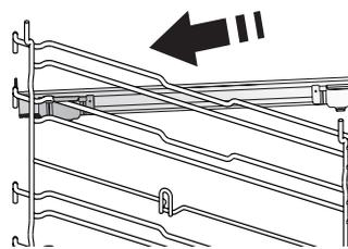
Iz pečice umaknite vodila za pekače in z drsnih vodil odstranite plastično zaščito.
