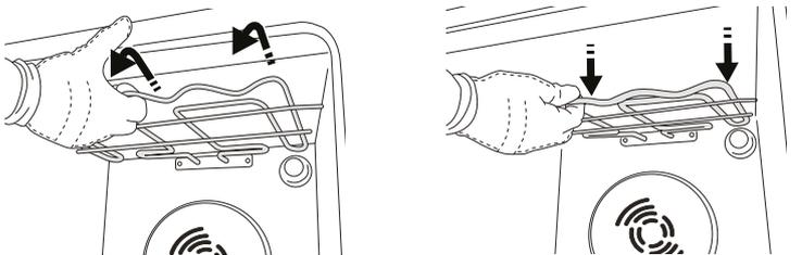
**3.** Za ponovno namještanje grijača, podignite lagano ga povlačeći prema sebi i provjerite je li sjeo na bočne nosače.
