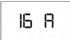
Otočením voliaceho gombíka vyberte menovitý prúd a potom potvrdte stlačením .
