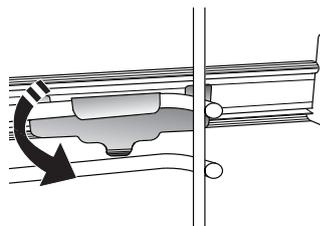
Vodilicu učvrstite tako da čvrsto pritisnete donji dio kopče na vodilicu rešetke. Provjerite mogu li se vodilice slobodno pomicati. Ove korake ponovite na drugoj vodilici rešetke na istoj razini.
