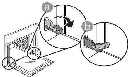
**2.** Dvířka dobře uzavřete. Pevně je držte oběma rukama – nedržte je za rukojeť. Dvířka snadno vysadíte tak, že je budete nepřetržitě zavírat a současně za ně táhnout, dokud se neuvolní z usazení. Odložte dvířka na stranu na měkký povrch.
