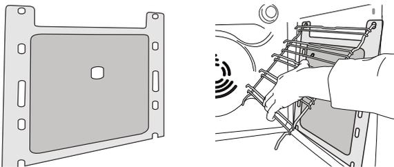
Za najbolje korišćenje funkcije samočišćenja katalitičkih ploča, preporučujemo grejanje rerne na 200 °C oko sat vremena pomoću funkcije „Konvekciono Pečenje“. Tokom ovog procesa, pećnica mora biti prazna. Zatim ostavite uređaj da se ohladi pre nego što neabrazivnim sunđerom skinete sve ostatke hrane.
