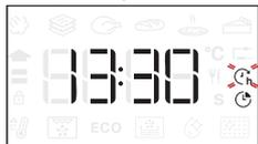
Szükség esetén forgassa el a beállítógombot a sütési idő kívánt végének beállításához, majd nyomja meg az gombot a jóváhagyáshoz és a funkció indításához.
