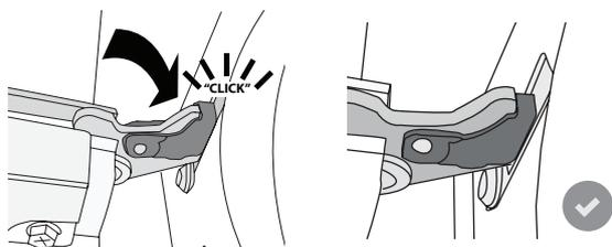
**5.** Proovige ust sulgeda ja vaadake, et see oleks juhtpaneeliga ühel joonel. Kui pole, korrake ülalkirjeldatud toiminguid: Kui uks ei liigu korralikult, võib see viga saada.
