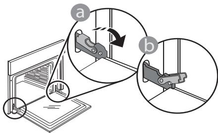
**2.** Sluit de deur zo ver mogelijk. Houd de deur stevig met beide handen beet – niet vasthouden aan de handgreep. Verwijder de deur door deze te blijven sluiten en tegelijkertijd omhoog te trekken totdat de deur loshaakt. Zet de deur opzij en laat deze op een zachte ondergrond rusten.
