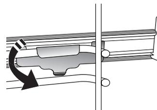
Para fixar a guia, pressione a parte inferior do dispositivo de fixação firmemente contra a guia de nível. Assegure-se de que as corredeiras se movem livremente. Repita estes procedimentos para a outra guia de nível, no mesmo nível.
