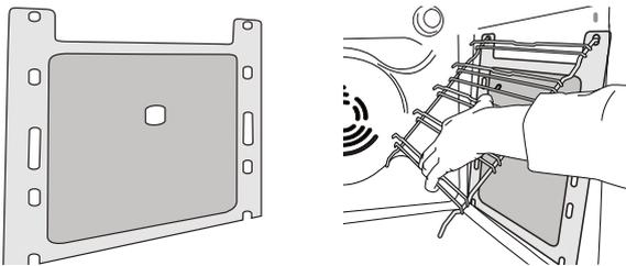
Katalüütiliste paneelide isepuhastustoime tõhusaks kasutamiseks soovime ahju kuumutada umbes tund aega 200 °C juures funktsiooniga "Convection Bake". Ahi peab sel ajal olema tühi. Enne järelejäänud toidujääkide eemaldamist pehme nuustikuga laske seadmel maha jahtuda.
