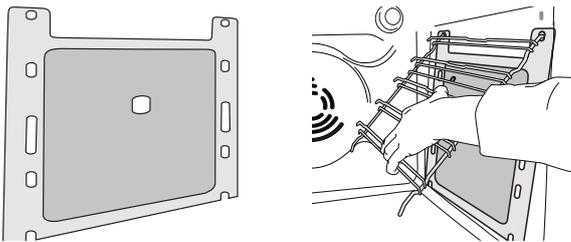
Pre najlepšie využitie samočistiacich vlastností katalytických panelov odporúčame zohrievať rúru na 200 °C zhruba jednu hodinu s funkciou „Konvenčné pečenie“. Rúra musí byť pritom prázdna. Potom nechajte rúru vychladnúť a odstráňte zvyšky jedla pomocou neabrazívnej špongie.
