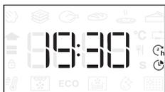
Upozornění: Naprogramování času spuštění odloženého pečení deaktivuje fázi předehřívání trouby: Trouba dosahuje požadované výše teploty postupně, což znamená, že doby přípravy mohou být o něco delší, než je uvedeno v tabulce pro tepelnou úpravu.
