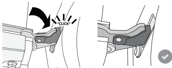
**5.** Pokušajte da zatvorite vrata i proverite da li su u istoj ravni sa kontrolnom tablom. Ukoliko nisu, ponovite gore opisane korake: Vrata se mogu oštetiti ukoliko nisu nameštena kako treba.
