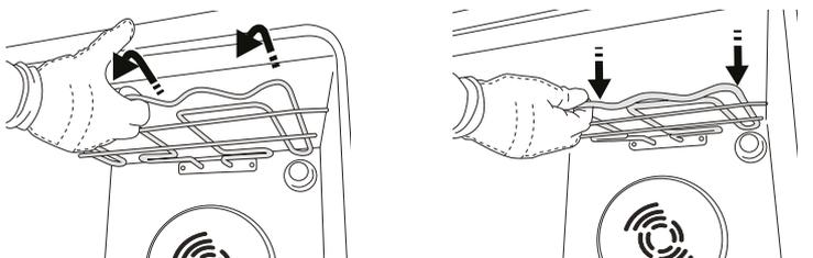
**3.** Zpět ho vrátíte tak, že ho zvednete nahoru a přitom mírně přitáhnete směrem k sobě. Zkontrolujte, zda leží na bočních držácích.
