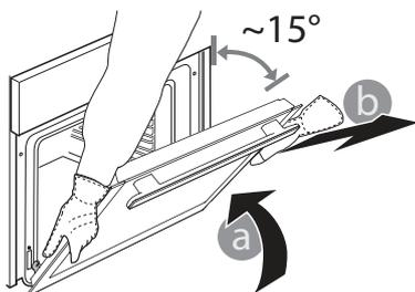
**3.** Ponovo postavite vrata tako što ćete ih podići ka pećnici, poravnati kuke šarki sa ležištem i pričvrstiti gornji deo na ležište.
