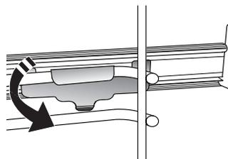
Da vodila zavarujete, spodnji del sponke čvrsto pritisnite na vodila za pekače. Prepričajte se, da je mogoče drsna vodila nemoteno premakniti. Postopek ponovite na drugem vodilu za pekače, ki je na enaki višini.
