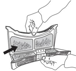
**4.** Nettoyez le compartiment du filtre avec un chiffon doux, ou minutieusement avec un aspirateur.
