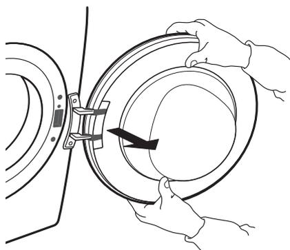
**5.** Fixez la porte sur le côté gauche en tournant les deux vis. Veillez à les serrer à la verticale pour éviter de pincer le joint de la porte.
