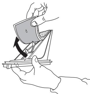
**4.** Nettoyez la mousse du filtre et le filtre à la main ou sous l'eau courante. Ne lavez pas la mousse du filtre dans la machine à laver.
