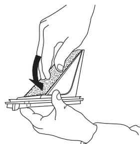
**7.** Nettoyez la chambre du filtre du sèche-linge avec un chiffon humide ou minutieusement avec un aspirateur.
