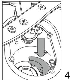
Depois de limpar os filtros, volte a colocar o conjunto de filtros e fixe-o corretamente na devida posição; isto é essencial para manter um funcionamento eficaz da máquina de lavar loiça.
