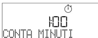
Dopo avere attivato il conta minuti, è anche possibile selezionare e attivare una funzione. Ruotare la *manopola di selezione* per selezionare la funzione desiderata.
