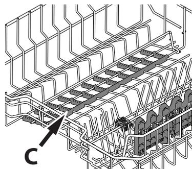
Der obere Korb verfügt über eine spezielle Silikonabdeckung **C**, die empfindliche Gegenstände wie Glas vor möglichen Schäden durch Kontakt mit den Korbbzinken schützt.
