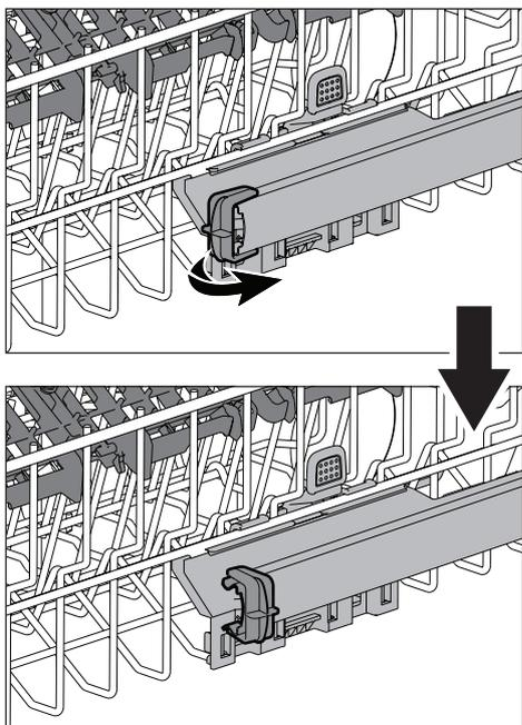
Ziehen Sie den Korb zu sich heran. Den Korb vollständig aus den Schienen herausziehen und nach außen schieben.
