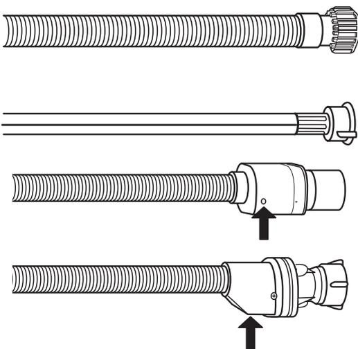
Wenn der Zulaufschlauch eine transparente Beschichtung hat, regelmäßig prüfen, ob die Farbe sich örtlich verstärkt. Wenn ja, könnte der Schlauch eine undichte Stelle haben und muss ausgetauscht werden.
