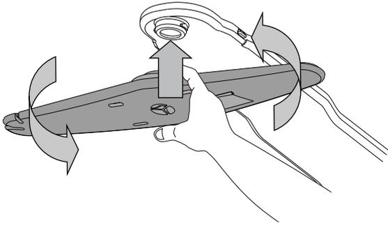
Der Deckensprüharm kann entfernt werden, indem er nach oben gedrückt und dann gegen den Uhrzeigersinn gedreht wird. Der Sprüharm wird wieder eingebaut, indem er nach oben gezogen und im Uhrzeigersinn gedreht wird.
