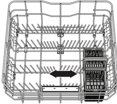
Der Unterkorb verfügt über klappbare Ablagen, die in vertikaler Stellung für Teller oder in horizontaler (niedriger) Position für Pfannen und Salatschüsseln verwendet werden können.
