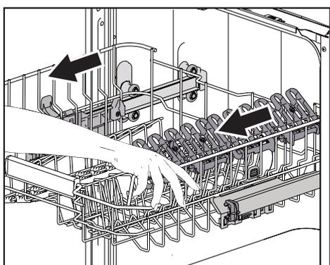
2. Entfernen Sie Speisereste und Schmutz, die sich auf den Schienen angesammelt haben, mit einer weichen Bürste oder einem feuchten Tuch.
