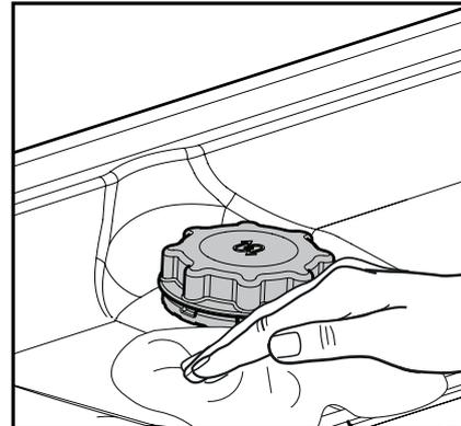
Sicherstellen, dass der Deckel fest angeschraubt ist, so dass kein Spülmittel während dem Waschprogramm in den Behälter gelangt (dies könnte den Wasserenthärter irreparabel beschädigen).
