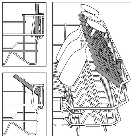
Die seitlich, klappbaren Ablagen können ein- oder aufgeklappt werden, um die Anordnung des Geschirrs im Korb zu optimieren.
