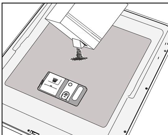
4. Entfernen Sie eventuelle Spülmittelrückstände von den Kanten der Kammern und schließen Sie den Deckel so, dass er einrastet. Schließen Sie den Deckel des Spülmittels, indem Sie ihn nach oben ziehen, bis der Verschluss einrastet.
