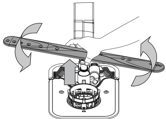
Um den unteren Sprüharm abzunehmen, diesen nach oben ziehen und gegen den Uhrzeigersinn drehen. Der Sprüharm wird wieder eingebaut, indem er nach unten gezogen und im Uhrzeigersinn gedreht wird.
