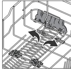
Zum Ausklappen der Klappstützen ziehen Sie diese bis zum hörbaren Klicken heraus. Das bedeutet, dass die Stütze durch den Verschluss sicher arretiert ist. So können Sie den Platz im Korb ganz einfach anpassen.
