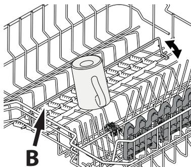
Der Oberkorb ist mit einem zusätzlichen Draht **B** ausgestattet, der in vertikaler Position das Ordnen des Geschirrs erleichtert. So können Gläser und Tassen schräg gestellt werden, sodass das Wasser ungehindert abfließen kann und sich nicht im oberen Bereich sammelt.
