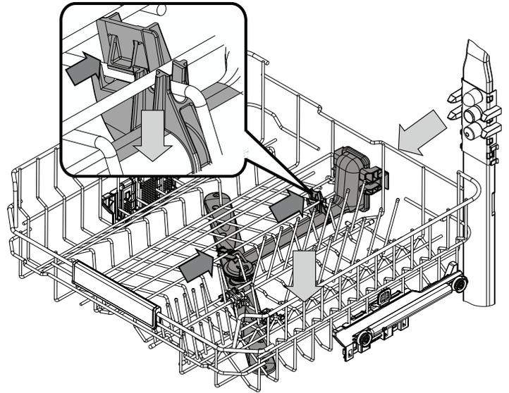
Es kann vorkommen, dass Speisereste an den Sprüharmen hängen bleiben und die Wasserdüsen verstopfen. Prüfen Sie die Sprüharme daher regelmäßig und reinigen Sie sie bei Bedarf mit einer Kunststoffbürste.
