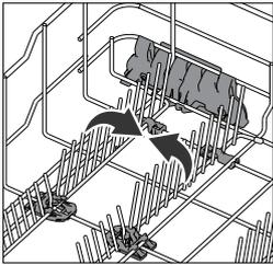
Das Einklappen der Klappstützen im Geschirrkorb geht einfach und schnell. Dazu einfach die Klappstützen in Pfeilrichtung schieben, bis sich die Verriegelung löst.
