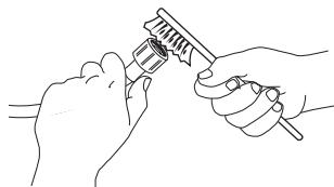
3. Maintenant, dévissez manuellement le tuyau d'arrivée situé à l'arrière du lave-linge. En utilisant une pince, retirez le filtre en maille de la vanne située à l'arrière du lave-linge et nettoyez-le avec soin.
