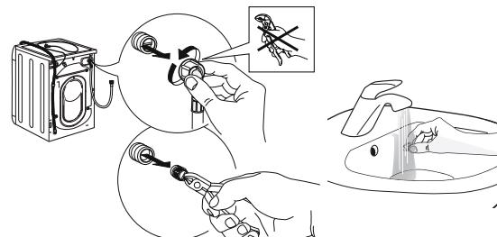
4. Remettez le filtre en maille en place. Raccordez de nouveau le tuyau d'arrivée d'eau au robinet et au lave-linge. N'utilisez pas d'outil pour raccorder le tuyau d'arrivée d'eau. Ouvrez le robinet d'eau et vérifiez que tous les raccords sont bien serrés.
