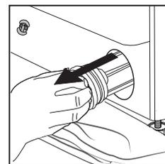
5. Limpe o filtro de água: remova os resíduos do filtro e lave-o com água corrente.
