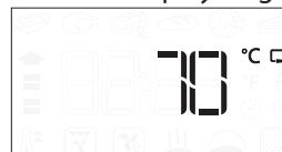
Wenn der Kerntemperaturfühler während der Auswahl einer Funktion eingesteckt wird, wechselt das Display zur Standard-Zieltemperatur des Kerntemperaturfühlers.
