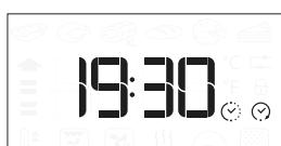
Note: programmare l'avvio ritardato di una cottura, disattiva in ogni caso la fase di preriscaldamento del forno: la temperatura desiderata viene raggiunta gradualmente, quindi i tempi di cottura si allungheranno leggermente rispetto a quanto indicato nella tabella di cottura.
