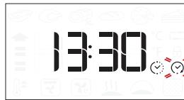
Bei Bedarf den Einstellknopf drehen, um das gewünschte Garzeitende einzustellen, anschließend mit ⌂ bestätigen und die Funktion starten. Die Speise in den Ofen stellen und die Tür schließen: Die Funktion startet automatisch nach der berechneten Zeit, damit der Garvorgang zur eingestellten Zeit endet.
