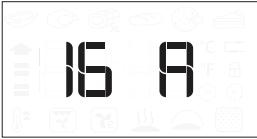
Den Auswahlknopf zur Auswahl des Nennstroms drehen, anschließend ⌂ zur Bestätigung drücken.
