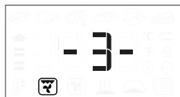
Bitte beachten: Nach dem Start der Funktion kann die Temperatur oder die Grillstufe durch Drücken von ⌂ oder direkt durch Drehen des Knopfes geändert werden.
