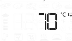
Als de gaarthermom wordt aangesloten tijdens de selectie van een functie, schakelt het display over naar de voorgeprogrammeerde doeltemperatuur van de gaarthermometer.
