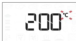
Wenn die Symbole °C/F auf dem Display blinken, den Knopf drehen, um den Wert zu ändern, anschließend ⌂ zur Bestätigung drücken und fortfahren, um die nachfolgenden Einstellungen zu ändern (falls möglich). Außerdem kann gleichzeitig die Grillstufe eingestellt werden (3 = hoch, 2 = mittel, 1 = niedrig).
