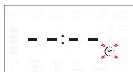
Wenn das Symbol ⌂ auf dem Display blinkt, den Einstellknopf zum Einstellen der gewünschten Garzeit verwenden, und anschließend ⌂ zur Bestätigung drücken. Die Garzeit muss nicht eingestellt werden, wenn der Garvorgang manuell gehandhabt wird: Drücken Sie ⌂ zum Bestätigen und Starten der Funktion. In diesem Fall kann kein Garzeitende durch Programmierung einer Startverzögerung eingestellt werden.
