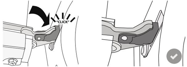
5. Zkuste dvířka zavřít a zkontrolujte, zda jsou v jedné rovině s ovládacím panelem. Pokud tomu tak není, výše uvedený postup opakujte: Pokud dvířka správně nefungují, mohou se poškodit.
