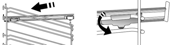
Upozornění: Posuvné drážky lze nainstalovat do kterékoli úrovně.
