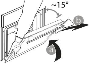
3. Dvířka opět nasadíte tak, že je přiložíte k troubě, nasměrujete háčky pantů oproti jejich usazení a do příslušného usazení zajistíte i horní část.
