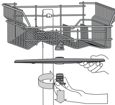
Zur Abnahme des oberen Sprüharms drehen Sie den Kunststoffring im Uhrzeigersinn ab. Der obere Sprüharm ist mit jener Seite nach oben wieder einzusetzen, die die meisten Löcher aufweist.
