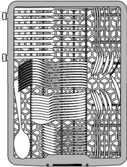
Die dritte Schublade wurde für das Hineinlegen von Besteck entwickelt. Platzieren Sie das Besteck wie abgebildet. Eine getrennte Anordnung des Bestecks macht das Sortieren nach dem Spülen einfacher und verbessert die Spül- und Trockenleistung.
