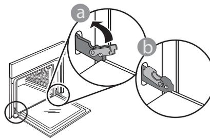
Aplicați o presiune ușoară pentru a verifica dacă dispozitivele de oprire se află în poziția corectă.
