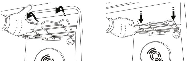
**3.** Varmeelementet sættes på plads igen ved at hæve det, idet du trækker det lidt mod dig selv. Sørg for, at varmeelementet anbringes korrekt på siderne.
