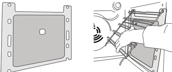
Om optimaal gebruik te maken van de zelfreinigende eigenschappen van de katalytische voeringen raden we aan de oven te verwarmen tot 200 °C gedurende ongeveer een uur, met de functie "Convectiebakken". De oven moet leeg zijn gedurende deze tijd. Laat het apparaat daarna afkoelen en gebruik een niet-schurende spons om eventuele etensresten te verwijderen.
