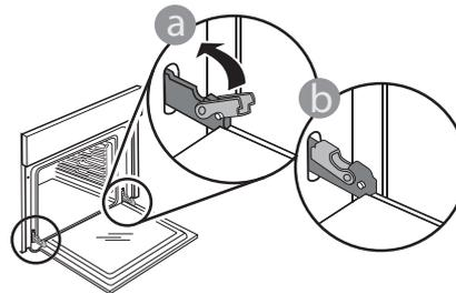
Udøv et let tryk, for at kontrollere at fæstelementerne er i den korrekte position.
