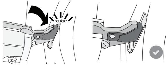
**5.** Yritä sulkea luukku ja varmista, että se on tasassa käyttöpaneelin kanssa. Jos näin ei ole, toista yllä olevat vaiheet: Jos luukku ei toimi oikein, se saattaa vahingoittua.
