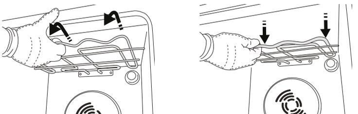
**3.** Para volver a situar la resistencia en su posición, elevarla, tirar de ella ligeramente hacia fuera y comprobar que queda apoyada en las sujeciones laterales.
