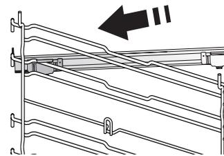
Retire as guias de nível do forno e remova o plástico de proteção das corredeiras.
