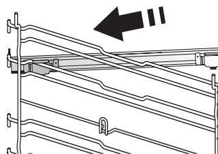
Vyberte vodiace lišty z rúry a z posuvných bežcov odstráňte ochranné plasty. Prípevnite vrchnú svorku bežca na vodiacu lištu a nasuňte, pokiaľ to ide. Druhú svorku spustite na miesto.
