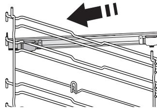
Ta bort ugnsstegen från ugnen och ta bort skyddsplasten från teleskopskenorna.
