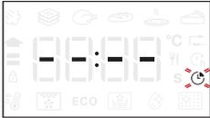
Wanneer het symbool knippert op de display, gebruik dan de instelknop om de gewenste bereidingstijd in te stellen en druk op om te bevestigen.
