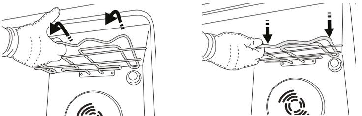
**3.** Um das Heizelement wieder korrekt einzusetzen, heben Sie es an und ziehen Sie es leicht zu sich her. Vergewissern Sie sich, dass es korrekt in den seitlichen Aussparungen sitzt.
