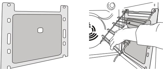
Um die selbstreinigenden Eigenschaften der katalytischen Wände bestmöglich zu nutzen, wird empfohlen, den Ofen für ungefähr eine Stunde auf 200 °C unter Verwendung der „Umluft“-Funktion aufzuheizen. Der Ofen muss während dieser Zeit leer sein. Anschließend das Gerät abkühlen lassen, bevor verbleibende Speisereste mit einem nicht scheuernden Schwamm entfernt werden.
