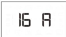
Obróć pokrętkę, aby wybrać prąd znamionowy, a następnie nacisnąć przycisk
