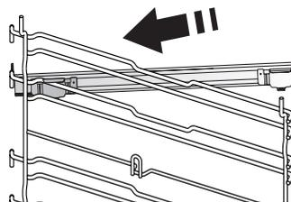
Demontați ghidajele pentru grătar din cuptor și îndepărtați folia protectoare din plastic de pe șinele culisante.
