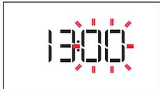
Les deux chiffres des minutes clignotent. Tourner le bouton pour régler les minutes et appuyer sur pour confirmer.
