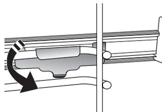
För att säkra sidostegen, tryck den nedre delen av klämman stadigt mot sidostegen. Säkerställ att teleskopskenorna kan röra sig fritt. Upprepa dessa steg på den andra ugnsstegen på samma nivå.
