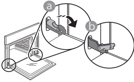
**2.** Chiudere la porta fino a quando è possibile. Prendere saldamente la porta con entrambe le mani, evitando di tenerla per la maniglia. È sufficiente rimuovere la porta continuando a chiuderla e tirandola contemporaneamente verso l'alto, finché non si sgancia dalla propria sede. Togliere la porta e appoggiarla su un piano morbido.
