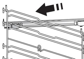
Z trouby odstraňte boční vodicí mřížky a z posuvných drážek ochranné fólie.
