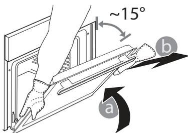
**3.** Remontați ușa deplasând-o spre cuptor, aliniind cuplajele balamalelor cu locașurile și fixând partea superioară în locaș.
