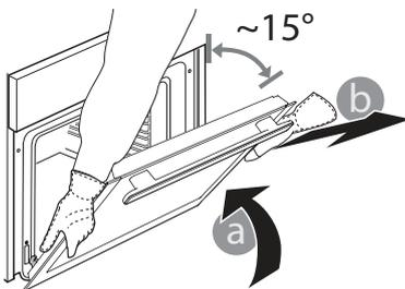
**3.** Vuelva a instalar la puerta llevándola hacia el horno, alineando los ganchos de las ranuras con sus alojamientos y fijando la parte superior en su alojamiento.
