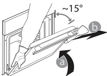
**3.** Ukse tagasi paigaldamiseks asetage see vastu ahju, joondage hingede haagid pesadega ja kinnitage ülemine osa oma pesa.
