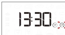
V případě potřeby otáčejte knoflíkem a nastavte požadovaný čas ukončení přípravy. Poté, pro potvrzení volby a spuštění funkce, stiskněte . Vložte pokrm do trouby a zavřete dvířka:
