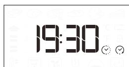
Huomaa: Kypsennyksen viivästetyn käynnistysajan ohjelmoiminen sulkee pois käytöstä uuniin esikuumennusvaiheen. Uuni saavuttaa haluamasi lämpötilan vaiheittain, minkä vuoksi kypsennysajat ovat hieman kypsennystaulukossa lueteltuja pitempia.
