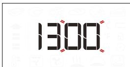
Na displeji začnou blikat dvě číslice nastavení minut. Pro nastavení minut otáčejte ovladačem a stisknutím volbu potvrďte.
