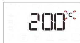
Când pictograma °C/°F clipește pe afișaj, rotiți butonul pentru modificarea valorii, apoi apăsați pentru confirmare și continuați să modificați următoarele setări (dacă este posibil).
