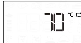
Hvis stegetermometeret sættes i stikket under markering af en funktion, vil displayvisualiseringen skifte til stegetermometerets defaultindstillede temperatur.
