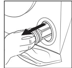
8. Abpumpfilter reinigen: Entfernen Sie Rückstände aus dem Filter und reinigen Sie ihn unter fließendem Wasser.
