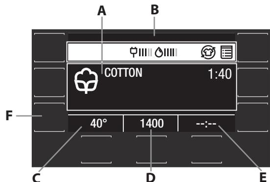
Indem Sie die Schaltflächen  $\triangle$  und  $\nabla$  betätigen, können Sie die gewünschte Option auswählen und über die Schaltfläche  $\checkmark$  bestätigen.
