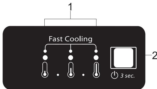
1. Anzeige-LEDs (zur Anzeige der aktuellen Temperaturinstellung oder der Schnellkühlfunktion)
