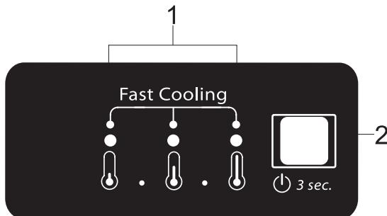
1. LEDs indicadores (apresentam a atual temperatura programada ou a função de Arrefecimento Rápido)
