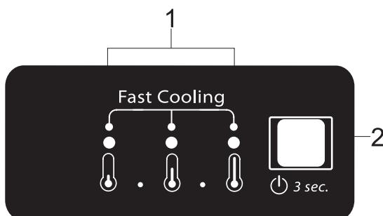
1. Wskaźniki LED (wyświetlają bieżącą wartość temperatury lub informują o funkcji Szybkiego chłodzenia)
