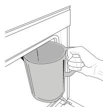
Αφού επιλέξετε τη λειτουργία "Αποστράγγιση", ακολουθήστε τις ενέργειες που υποδεικνύονται: Ανοίξτε την πόρτα και τοποθετήστε μια μεγάλη κανάτα κάτω από το ακροφύσιο αποστράγγισης που βρίσκεται στην κάτω δεξιά πλευρά του πίνακα. Μόλις ξεκινήσει η αποστράγγιση, κρατήστε
