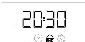
Notas: Para cancelar la configuración, apague el horno girando el **selector** hasta la posición «**0**».
