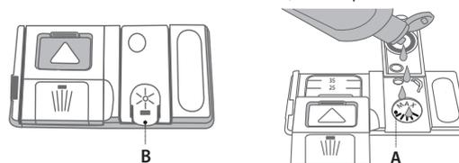
1. Ouvrez le distributeur **B** en appuyant et en tirant sur l'onglet sur le couvercle.
