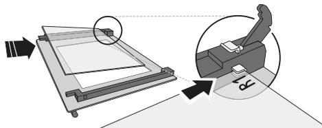
4. Remplacez le bord supérieur : un déclic indique qu'il est bien placé. Assurez-vous que le joint est bien placé avant de remonter la porte.
