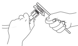
3. Draai nu met de hand de toevoerslang op de achterkant van de wasmachine los. Trek het filter met een tang uit de klep op de achterkant van de wasmachine en maak het zorgvuldig schoon.
