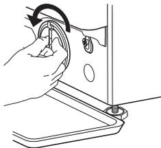
9. Entfernen Sie den Filter: Legen Sie ein Baumwolltuch unter den Wasserfilter, der eine geringe Menge an Restwasser aufnehmen kann. Entfernen Sie dann den Wasserfilter indem Sie ihn gegen den Uhrzeigersinn herausdrehen.
