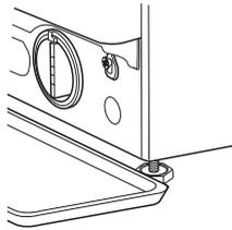
8. Entleeren Sie das Wasser: Drehen Sie den Filter langsam gegen den Uhrzeigersinn, bis das gesamte Wasser herausgeflossen ist. Lassen Sie das Wasser ausfließen, ohne den Filter zu entfernen. Sobald der Behälter voll ist, schließen Sie den Wasserfilter indem Sie ihn im Uhrzeigersinn drehen. Entleeren Sie den Behälter. Wiederholen Sie den Vorgang, bis das gesamte Wasser abgelassen ist.
