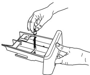
3. Reinigen Sie alle Teile unter fließendem Wasser und entfernen Sie alle Waschmittel- und Weichspülerrückstände.
