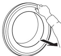
Zum Schließen der Tür, halten Sie den Griff und drücken Sie so, dass Sie die Verriegelung einrasten hören.
