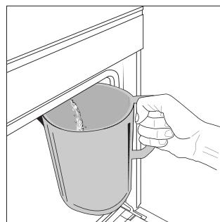
Uma vez selecionada a função "Drenagem" ou quando requerido através de uma mensagem no visor, inicie esta função e siga as instruções indicadas: Abra a porta e coloque um jarro grande (com capacidade para, pelo menos, 2 litros de água) por baixo do bico de drenagem localizado na parte inferior do painel, do lado
