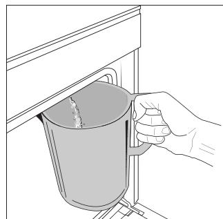
Zodra u de functie "Afvoeren" heeft geselecteerd of wanneer het display het aanvraagt, start u de functie en voert u de aangegeven handelingen uit: Open de deur en plaats een grote kan (ten minste 2 liter) onder het afvoermondstuk aan de onderkant van het paneel, links van het inlaatmondstuk. Indien nodig, is het mogelijk om het bedieningspaneel te gebruiken om het afvoerproces te pauzeren en te hervatten (bijvoorbeeld in het geval dat de kan al vol water zit in het midden van het afvoerproces).
