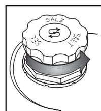
Indicador visual (conforme o modelo). Desaperte a tampa.
