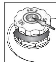
Aberte a tampa. Os resíduos de sal à volta da tampa devem ser removidos. Alguns depósitos de sal têm um indicador de nível integrado na tampa (veja abaixo como verificar).
