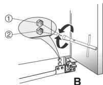
5. Bruk nøkkelen som følger med (noen modeller) for å regulere nivelleringskruene. Roter med urviseren for å heve og mot urviseren for å senke apparatet. Det kan være nødvendig å skru nivelleringskruene og/eller fottene flere omdreininger for å justere hellingen på kjøleskapet.
