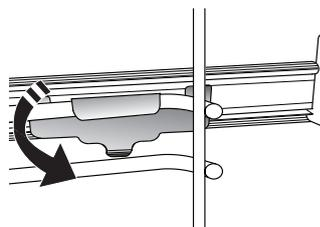
Die Seitengitter aus dem Ofen nehmen und den Kunststoffschutz von den Backauszügen entfernen.
