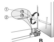
**5.** Utilize a chave fornecida, se estiver presente, para regular os parafusos de nivelamento. Rode no sentido dos ponteiros do relógio para levantar o frigorífico, ou no sentido contrário para abaixá-lo. Poderá vir a ser necessário rodar os parafusos de nivelamento e/ou os pézinhos várias vezes, até regular a inclinação do frigorífico.
