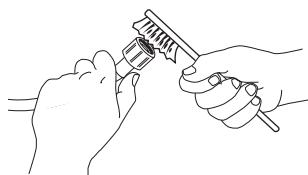
3. Maintenant, dévissez manuellement le tuyau d'arrivée situé à l'arrière du lave-linge. En utilisant une pince, retirez le filtre en maille de la vanne située à l'arrière du lave-linge et nettoyez-le avec soin.
