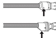
Pour les tuyaux équipés d'une protection contre les fuites : vérifiez la fenêtre d'inspection de la soupape de sécurité (voir la flèche). Si elle est rouge, la fonction de protection contre les fuites s'est déclenchée et le tuyau doit être remplacé par un tuyau neuf.
