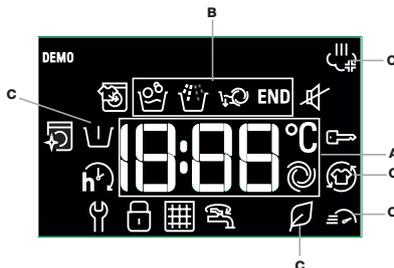
Die Dauer der verfügbaren Waschgänge und die Restzeit des aktuellen Waschgangs werden im Bereich **A** angezeigt (das Display zeigt zunächst die maximale Dauer des gewählten Waschgangs an, die nach ein paar Minuten abnehmen kann, da die tatsächliche Dauer eines Waschprogramms von der Wäscheladung und den gewählten Einstellungen abhängt).
