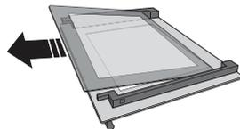
3 Per riposizionare correttamente il vetro interno, fare attenzione che la "R" sia leggibile nell'angolo destro e che la superficie lucida (non stampata) sia rivolta verso l'alto. Inserire dapprima il lato lungo del vetro indicato dalla "R" nelle sedi di sostegno, quindi abbassarlo in posizione (4). Rimontare il profilo superiore (5): un clic indica il corretto posizionamento. Verificare che la tenuta sia salda prima di rimontare la porta.
