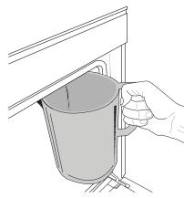
Kada odaberete funkciju „Ispuštanje“, pratite navedene radnje: Otvorite vrata i stavite široku posudu ispod mlaznice za ispuštanje u donjem desnom dijelu ploče. Nakon početka ispuštanja posudu u tom položaju držite sve dok zahvat ne završi. Potrebno je prosječno oko tri minute za ispuštanje cijelog punjenja.
