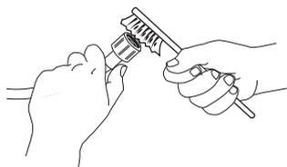
3. Desenrosque agora manualmente o tubo de entrada na parte de trás da máquina de lavar. Retire com um alicate o filtro de rede da válvula na parte de trás da máquina de lavar e limpe-o cuidadosamente.
