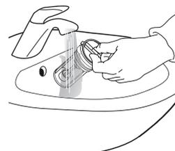
6. Insira o filtro de água e volte a instalar o rodapé: reintroduza o filtro de água, rodando-o no sentido dos ponteiros do relógio. Certifique-se de que o roda ao máximo; a pega do filtro deve estar na posição vertical. Para testar a estanqueidade do filtro de água, pode deitar cerca de 1 litro de água no dispensador de detergente. Em seguida, volte a instalar o rodapé.
