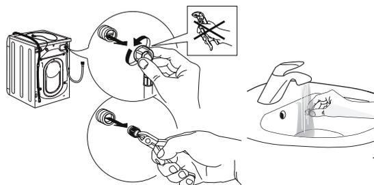
4. Volte a inserir o filtro de rede. Ligue novamente o tubo de entrada à torneira de água e à máquina de lavar. Não utilize ferramentas para ligar o tubo de entrada. Abra a torneira de água e verifique se todas as ligações estão apertadas.
