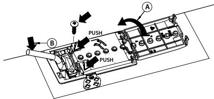
**Spotrebič musí byť pripojený k zdroju napájania prostredníctvom viacpolového spínača s minimálnou vzdialenosťou medzi kontaktmi 3 mm.**
