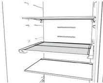
2. Halv dybde, for at bruge den bagerste del og dermed skabe plads til høje genstande (såsom flasker og kander) på den underliggende hylde. Hylden foldes sammen til den halve dybde ved at løfte det forreste afsnit en smule og herefter skub det indad.
