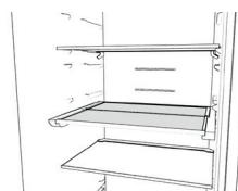
2. Puolen syvyyden verran, takaosan käyttämiseksi siten, että alahyllyllä oleville korkeammille esineille (kuten esimerkiksi pulloille ja kannuille) jää tilaa. Hyllyn syvyys säädetään puoleen nostamalla hieman etuosaa ja vetämällä se sitten sisään.
