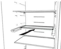
3. Vippet op, hvis du har brug for at skabe plads til høje eller store genstande på den underliggende hylde. Før hylden vippes op, skal den justeres til positionen halvejs fra den halve dybde. Vip hylden ned igen, for at vende tilbage til at bruge den i halv et fuld dybde.
