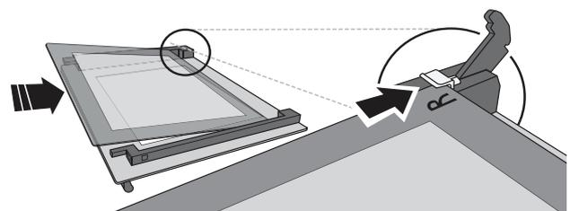
**4.** Remplacez le bord supérieur : un déclic indique le positionnement correct. Assurez-vous que le joint est bien placé avant de replacer la porte.
