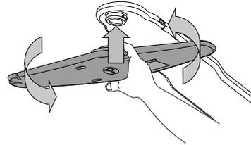
Um den oberen Sprüharm abzunehmen, diesen nach oben drücken und gegen den Uhrzeigersinn drehen. Der Sprüharm wird wieder eingebaut, indem er nach oben gezogen und im Uhrzeigersinn gedreht wird.
