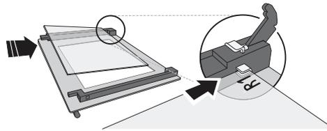
4. Rimontare il profilo superiore: Un clic indicherà il posizionamento corretto. Verificare che la tenuta sia salda prima di rimontare la porta.
