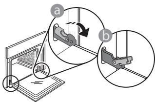
1. Per rimuovere la porta, aprirla completamente e abbassare i fermi fino alla posizione di sblocco.
