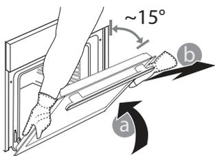
2. Chiudere la porta fino a quando è possibile. Prendere saldamente la porta con entrambe le mani, evitando di tenerla per la maniglia. È sufficiente rimuovere la porta continuando a chiuderla e
