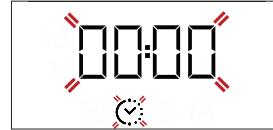
За допомогою кнопки або встановіть бажаний час готування, потім натисніть для підтвердження. Активуйте функцію, встановивши ручку терmostата на бажану температуру: Пролунає звуковий сигнал і на дисплеї з'явиться повідомлення про те, що приготування їжі завершено.
