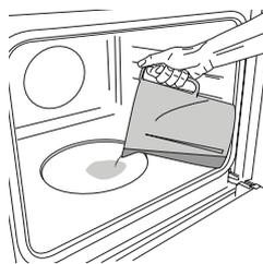
Pred spustením funkcie Para nalejte na dno rúry 200 ml pitnej vody. Otočením voliaceho gombíka doprava na príslušnú ikonku zvolte funkciu a gombík termostatu otočte do ktorejkoľvek polohy medzi 160 a 180 °C (ako naznačuje ikonka). Funkcia sa spustí a na displeji sa zobrazí aktuálny čas. Predohrev nie je potrebný. Ak chcete prípravu jedla ukončiť, otočte voliaci gombík do polohy 0. Počas prípravy jedla s parou dvierka neotvárajte a nikdy vodu nedoplňajte.
