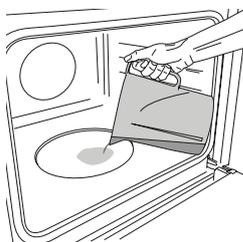
Pred vklopom funkcije uporabe pare na dno pečice nalijte 200 ml pitne vode. Izberite funkcijo, tako da *izbirni gumb* zavrtite v smeri urinega kazalca na ustrezni simbol, gumb za nastavitev temperature pa v poljubni položaj med 160 in 180 °C (kot prikazuje simbol). Funkcija se bo zagnala, na zaslonu pa bo prikazan trenutni čas v dnevu. Predgretje ni potrebno. Za končanje pečenja zavrtite *izbirni gumb* v položaj 0. Med kuhanjem s paro ne odpirajte vrat in nikoli ne dolivajte vode.
