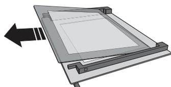
3. Znovu nasadte střední tabuli (označenou písmenem „R“) před nasazením vnitřní tabule: Při správném usazení tabule je symbol „R“ v levém rohu. Nejprve zasadte delší stranu skla označenou písmenem „R“ do rámečku a poté sklo sklopte do správné polohy. Tento postup opakujte s oběma tabulemi skla.
