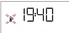
Opomba: med pripravo hrane lahko funkcijo spremenite tako, da zavrtite *izbirni gumb* ali da spremenite temperaturo z gumbom za nastavitev temperature. Funkcija se ne bo vklopila, če je vrtljiv gumb za nastavitev temperature v položaju 0 / AUTO. Nastavite lahko čas priprave, čas konca priprave (samo, če nastavite čas priprave) in časovnik.
