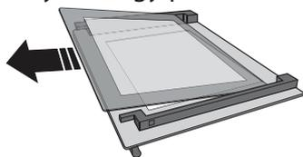
3. Helyezze vissza a középső keretet („R”-rel jelölve) a belső keret visszahelyezése előtt: A keretek helyes elhelyezéséhez ügyeljen arra, hogy az „R” jelzés a bal oldali sarokba kerüljön. Először csúsztassa az üveglap hosszanti, „R” jelzésű oldalát az illesztékekbe, majd engedje le a helyére. Ismételje meg a műveletet mindkét üveglappal.
