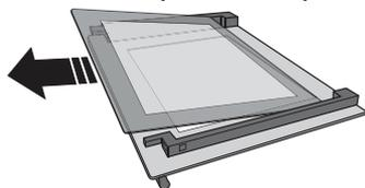
3. Ponovno namestite vmesno steklo (označeno z „R“) pred ponovnim nameščanjem notranjega stekla: Za ustrezno ponovno namestitev notranjega stekla se prepričajte, da je v levem vogalu vidna črka „R“. V držali najprej vstavite dolgo stranico stekla, označeno z „R“, in steklo nato spustite v ustrezni položaj. Ta postopek ponovite za obe stekli.
