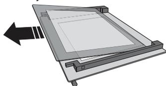
3. Ponownie zamontować środkowy panel (oznaczony literą "R") przed przystąpieniem do montażu panelu wewnętrznego: Aby właściwie umieścić szyby, należy upewnić się, że znak „R” jest widoczny w lewym rogu. W pierwszej kolejności należy umieścić dłuższą część szyby oznaczoną literą „R” w odpowiednich uchwytach, a następnie obniżyć ją do właściwej pozycji. Powtórzyć tę procedurę dla obu szyb.
