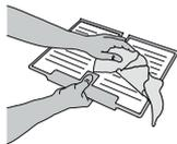
6. Włożyć akcesoria z powrotem, umieszczając tylną część w zagłębieniach pokazanych na rysunku, a następnie przymocować uchwyt w zapięciach powyżej.
