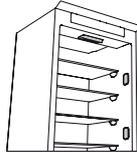
Този уред съдържа 4 странични светлинни източника с клас на енергийна ефективност F и горен светлинен източник с клас на енергийна ефективност G
