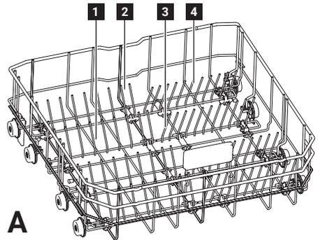
Abbildung 5: Anzahl der klappbaren Drähte im unteren Korb
