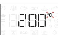
Cuando el ícono °C parpadee en la pantalla, gire el mando para modificar el valor y, a continuación, pulse para confirmar y continuar modificando los ajustes siguientes (si es posible).
