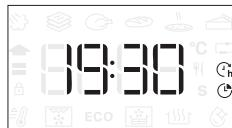
Note: La programmazione dell'avvio ritardato di una cottura disattiva la fase di preriscaldamento del forno: la temperatura desiderata viene raggiunta gradualmente, quindi i tempi di cottura si allungheranno leggermente rispetto a quanto indicato nella tabella di cottura.
