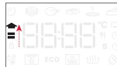
Kun tämä vaihe on päättynyt, kuuluu äänimerkki ja näyttö osoittaa, että uuni on saavuttanut asetetun lämpötilan.
