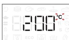
Wenn das Symbol °C auf dem Display blinkt, den Knopf drehen, um den Wert zu ändern, anschließend zur Bestätigung drücken und fortfahren, um die nachfolgenden Einstellungen zu ändern (falls möglich). Außerdem kann gleichzeitig die Grillstufe eingestellt werden (3 = hoch, 2 = mittel, 1 = niedrig).
