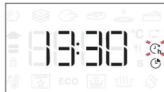
Bei Bedarf den Einstellknopf drehen, um das gewünschte Garzeitende einzustellen, anschließend mit bestätigen und die Funktion starten.
