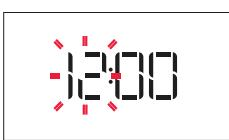
Op het display knipperen de twee cijfers die de uren aangeven: Draai aan de knop om de uren in te stellen en druk op om te bevestigen.
