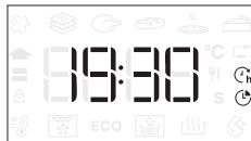
Huomaa: Viivästetyn käynnistysajan ohjelointi poistaa uunin esikuumennusajan: Uuni saavuttaa haluamasi lämpötilan asteittain, joka tarkoittaa, että kypsennysaika on hieman pidempi kuin kypsennystaulukossa kuvattu. Odotusaikana voit käyttää nuppia ohjelmoidun päätymisajan muuttamiseen.
