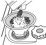
1. Togliere il cestello inferiore e svitare il tappo del serbatoio (ruotare in senso antiorario).
