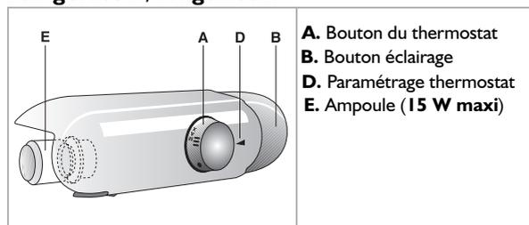
Thermostat réglé sur **1/MIN** : refroidissement **minimum**
