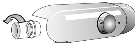
Avant de remplacer l'ampoule, débranchez toujours l'appareil. Immédiatement après :
