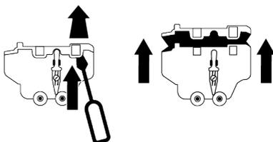
7. Rimuovi le linguette che fissano il coperchio superiore del cassetto del detersivo con un cacciavite a testa piatta (ci sono 6 linguette in totale, due ciascuna a destra, a sinistra e sul retro del cassetto) e lava l'interno del cassetto.
