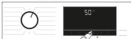
1. Premere il tasto per il Dosaggio automatico. Quando il detersivo liquido è attivo e l'ammorbidente spento, la schermata di impostazione del detersivo liquido diventa attiva. Quando il detersivo liquido è spento e l'ammorbidente è attivo, la schermata di impostazione del detersivo liquido diventa attiva. Il LED della schermata di impostazione attiva si accende.
