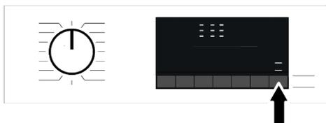
Quando il controllo remoto è attivato, è possibile solo gestire la macchina, spegnerla e seguire lo stato attraverso la lavatrice. Tutte le funzioni eccetto il blocco bambini possono essere gestite tramite l'applicazione.
