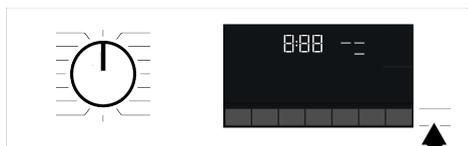
Se il livello dell'acqua nella macchina è insufficiente quando si preme il pulsante Avvio/Pausa, la serratura della porta non può essere disattivata e l'icona della serratura della porta continuerà a comparire sul display.
