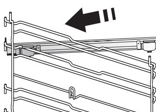
Витягніть напрямні для решітки із духової шафи і зніміть захисні пластмасові елементи на телескопічних напрямних. Замкніть верхній затискач телескопічної напрямної на напрямній для решітки та просуньте його вздовж напрямної до упору. Опустіть на місце інший затискач.
