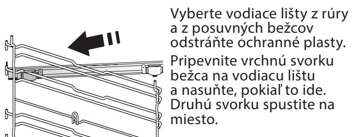
Vyberte vodiacie lišty z rúry a z posuvných bežcov odstráňte ochranné plasty. Pripevnite vrchnú svorku bežca na vodiacu lištu a nasuňte, pokiaľ to ide. Druhú svorku spustite na miesto.
