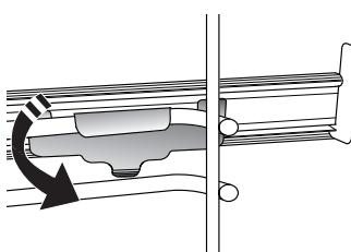
Щоб зафіксувати напрямну, міцно притисніть нижню частину затискача до напрямної для полички. Переконайтесь, що руху телескопічних напрямних нічого не заважає. Повторіть ці дії з іншою напрямною для решітки на тому ж рівні.
