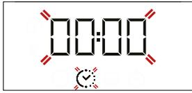
Utilice  $\pm$  o  $\bar{\pm}$  para configurar el tiempo de cocción deseado y después pulse
