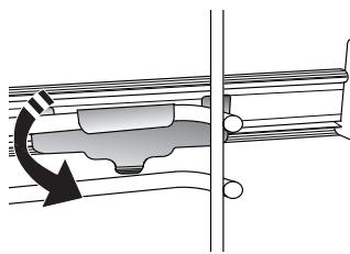
Pour fixer le guide, pressez la partie inférieure de lagrafe fermement sur le support de grille. Assurez-vous que les rails peuvent se déplacer librement. Répétez ces étapes pour l'autre support de grille du même niveau.
