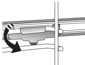
Para fixar a guia, pressione a parte inferior do dispositivo de fixação firmemente contra a guia de nível. Assegure-se de que as corrediças se movem livremente. Repita estes procedimentos para a outra guia de nível, no mesmo nível.
