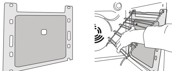
Para fazer o melhor uso possível das propriedades de limpeza automática dos painéis catalíticos, recomendamos que aqueça o forno a 200 °C durante cerca de uma hora, utilizando a função "Cozedura Convecção". Durante este período de tempo, o forno deverá estar vazio. Deixe o aparelho arrefecer antes de remover quaisquer resíduos de alimentos através de uma esponja não abrasiva.
