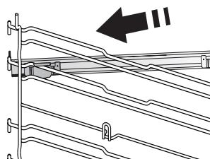
Retire as guias de nível do forno e remova o plástico de proteção das corrediças. Fixe o encaixe superior da corrediça à guia de nível e faça-a deslizar até parar. Baixe o outro encaixe para o posicionar.
