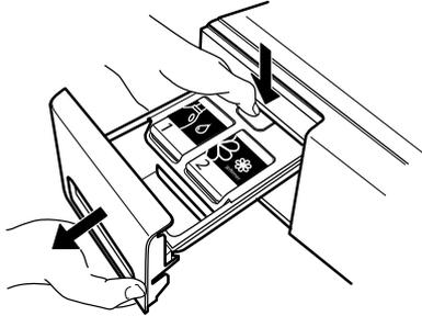
**2.** Enlevez soigneusement le couvercle du distributeur de détergent. Tout en l'enlevant, prenez garde aux pièces fonctionnelles du côté inférieur du couvercle.
