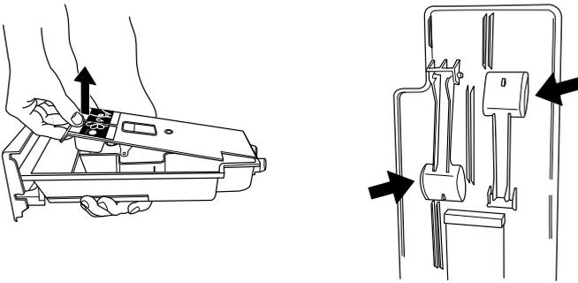
**3.** FACULTATIF : Si un réservoir contient toujours une bonne quantité de détergent ou d'assouplissant, ils peuvent être récupérés pour être utilisés plus tard. Les deux butées en caoutchouc, sur la partie inférieure arrière du distributeur de détergent, peuvent être enlevées. Au besoin, enlevez la butée et recueillez le détergent ou l'assouplissant qui s'écoule dans un récipient.
