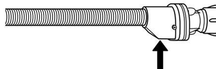
Pour les tuyaux d'arrêt d'eau : vérifiez la fenêtre d'inspection de la petite soupape de sécurité (voir la flèche). Si elle est rouge, la fonction d'arrêt d'eau a été déclenchée et le tuyau doit être remplacé. Pour dévisser ce tuyau, appuyez sur le petit bouton déclencheur sous la pièce de connexion (selon le modèle) tout en dévissant le tuyau.
