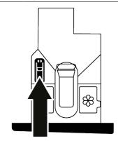
Presione sobre el elemento indicado por la flecha y tire del cajón de detergente hacia usted y retírelo.
