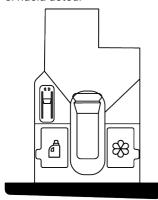
Para llenar el detergente líquido (izquierda) y el suavizante (derecha), abra la tapa del tanque respectivo hacia arriba como se muestra en la figura.
