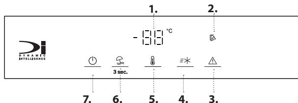
1. Lämpötilan näyttö
